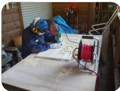
道路に立てる「青葉の森入り口」を案内する看板を作っているところです。細かい削りクズが飛び散り、電動工具の騒音も凄いのので、装備万端で作業中！
