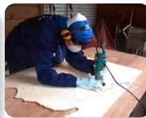
②等高線どおりに板を切り抜きます。
